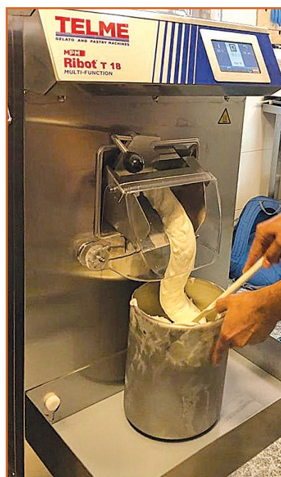
■ Ribot: – produkcja kremów, lodów, sorbetów, zup i sosów – gotowanie, chłodzenie, krojenie.
