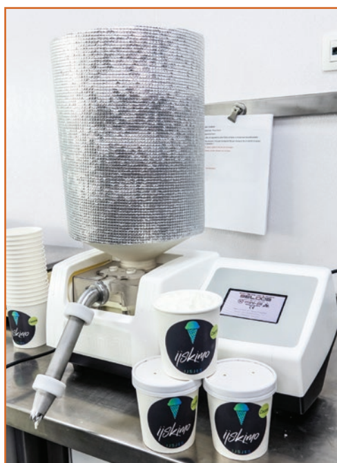
■ Dozownik Minifill: – dozowanie kremów, zimnych lodów, ciepłych zup i sosów – wszechstronny dozownik z wymiennymi końcówkami i lejami.
